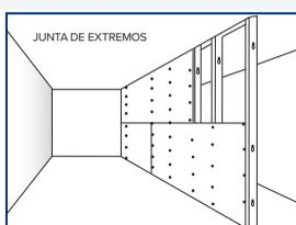
Fije el panel con tornillo de 1 1/8" para panel a cada 30 cm a lo largo de los postes intermedios y a cada 20 cm en postes extremos. El panel deberá quedar con una separación de 1/2" arriba del piso. Las juntas de bordes y extremos entre paneles deberán quedar perfectamente unidos.
