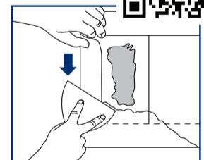
Dé acabado con compuesto para juntas, como en las juntas de extremo.
