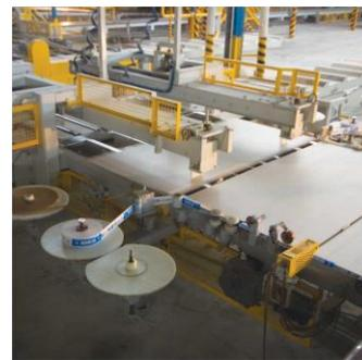
Cortado y seco el panel recibe el etiquetado para su identificación
