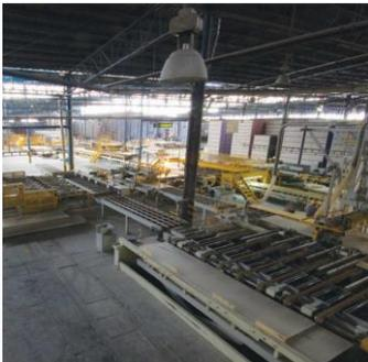
La piedra de alta pureza empieza a mezclarse con agua para conseguir la pasta del núcleo.
